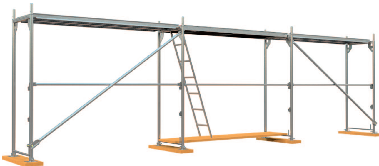
Rys. 8. Zastosowanie desek do podparcia drabiny najniższej kondygnacji
