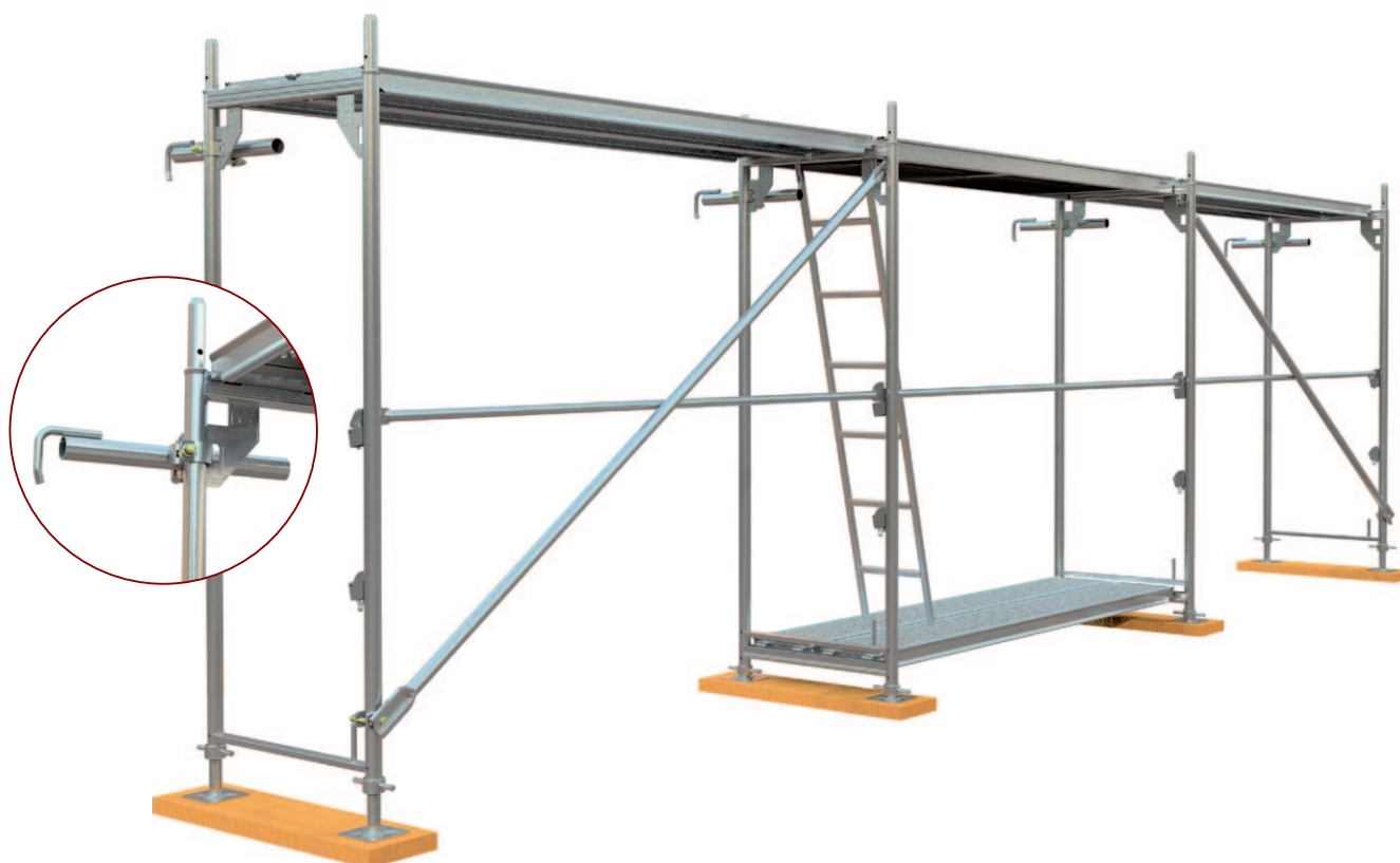
Rys. 10. Montaż łączników kotwiących pierwszej kondygnacji
